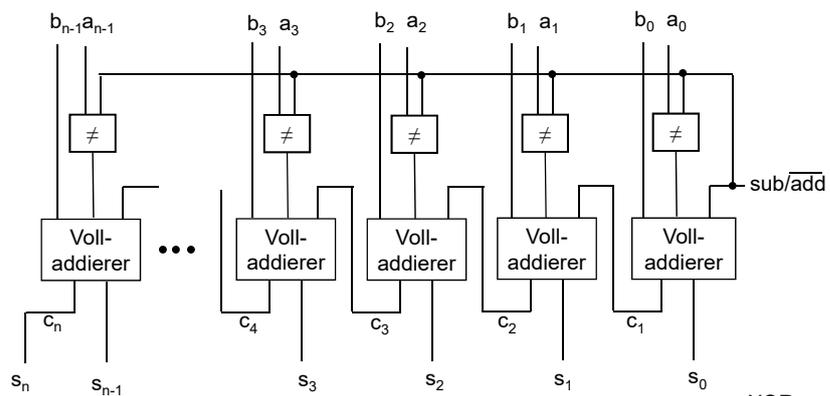
Vereinfachung: Inverter und 2-auf-1 Multiplexer, realisiert durch XOR-Gatter
