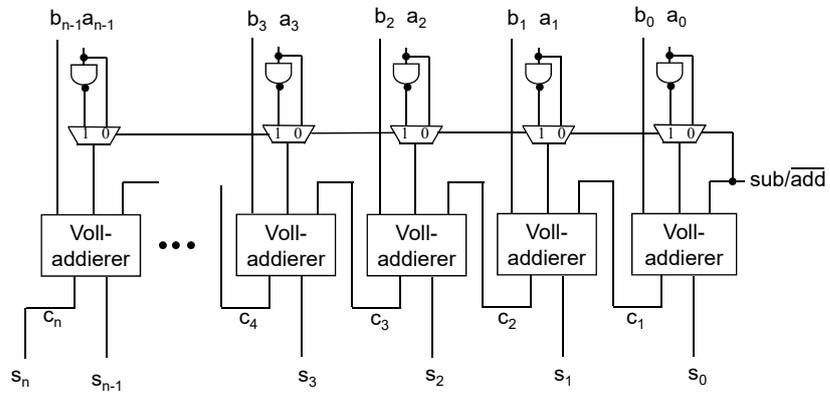
Umschaltung von Datum und deren Invertierung durch 2-auf-1 Multiplexer
